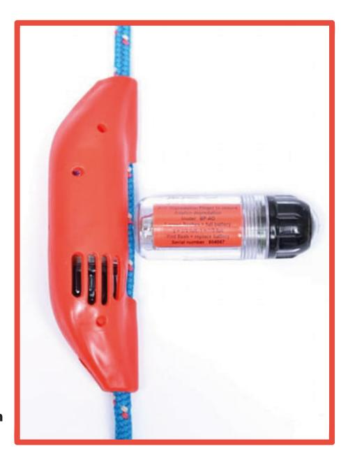
L'unità pinger può essere sostituita con un'unità di riserva con una batteria nuova in modo che la batteria possa essere sostituita in un luogo asciutto – non è necessario slegare! Il peso immerso in acqua è di 37 g (rispetto ai pesi immersi fino a 120 g per altri pinger sul mercato) quindi può essere infilato sulle corde che uniscono i pannelli della rete sulla fune della testa o del piede senza interferire con l'insieme della rete
